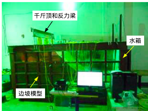
图 7 边坡模型试验箱
